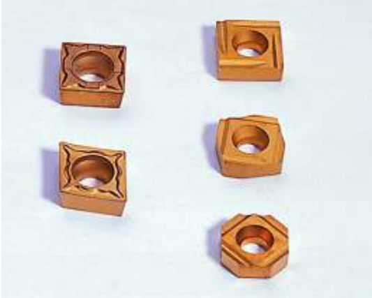
DIN - Platten: Form SCMT und Form CCMT
