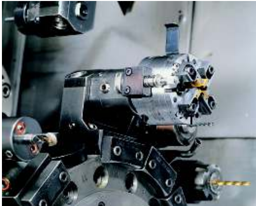
MSD 20 mit Außenauslösung auf einem Werkzeugrevolver aufgebaut
