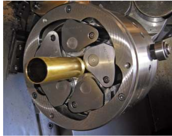
Rollen auf Rohr mit WAGNER® - RS 60-5
